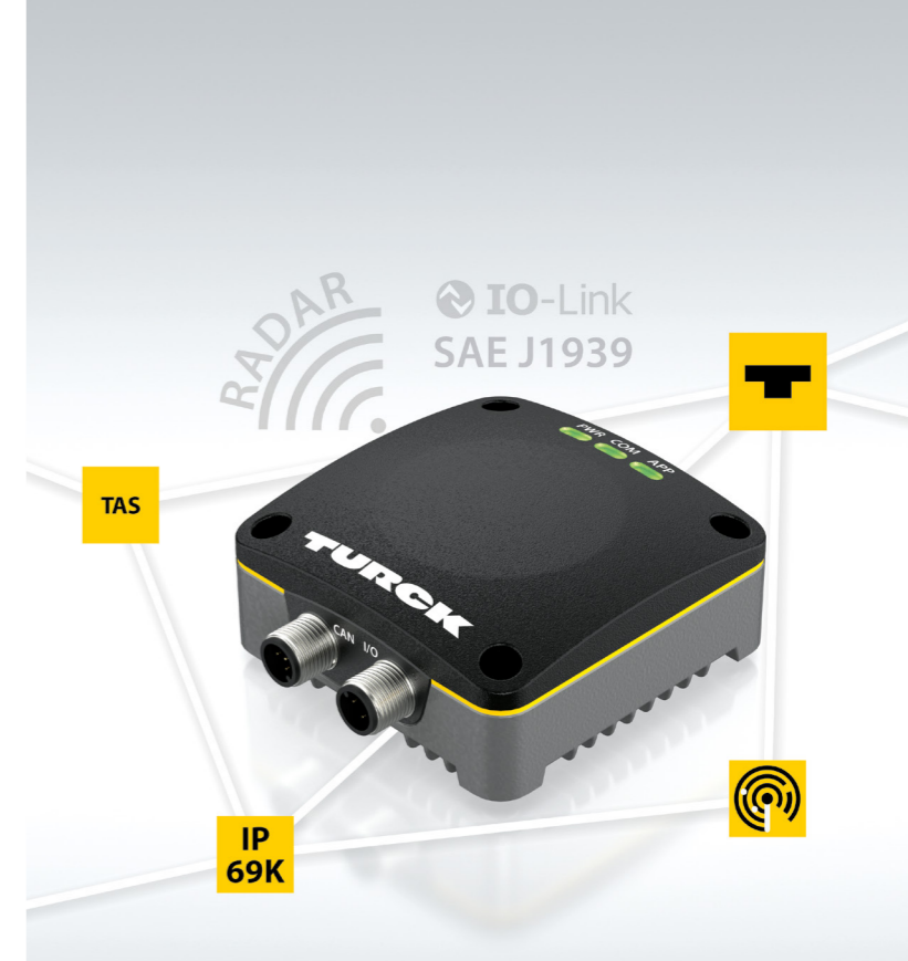
Skaner radarowy MR15-Q80 firmy Turck jest obecnie jedynym urządzeniem wyposażonym w interfejs SAE-J1939 dla magistrali CAN; dostępna jest również wersja IO-Link
