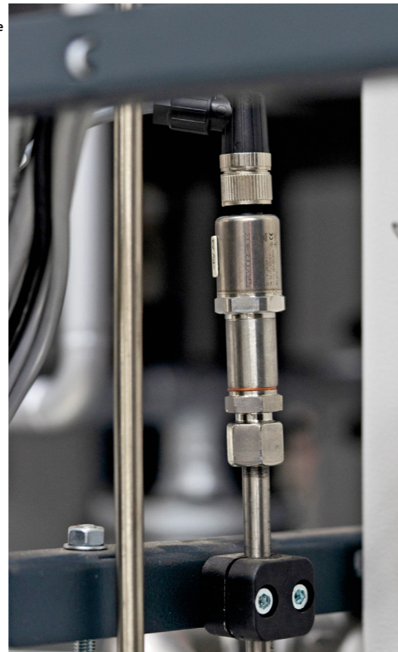
Kompaktowe czujniki ciśnienia PT dokładnie mierzą ciśnienie w układzie
