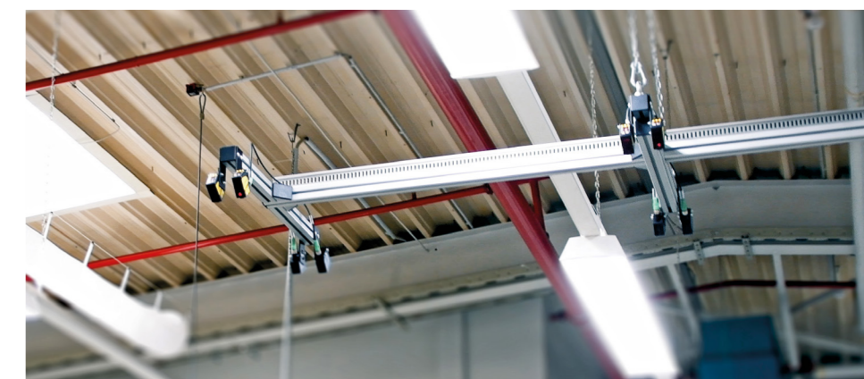
Laserowe czujniki odległości Q5X zamontowane na wysokości trzech metrów sprawdzają, czy w punkcie przeładunku znajdują się palety
