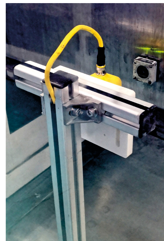
Głowice odczytu/zapisu HF na każdym stanowisku procesowym zapewniają niezawodne pozyskiwanie danych
