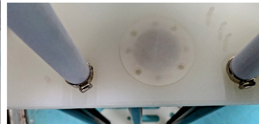
Zintegrowany znacznik RFID umożliwia jednoznaczny identyfikację każdego nośnika płytek i przypisanie go do zlecenia produkcyjnego
